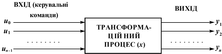
Рис. 7.9 Схема елементарної операційної системи керування
