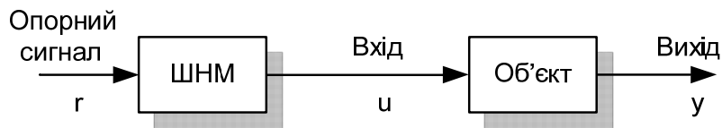
Рис. 10.8. Послідовна схема нейрокерування
