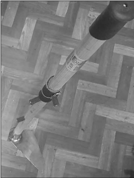
Рис. 5. Екзоскелетна мотика-плоскоріз Розума ПР-2 (використовується при створенні ТГР)
