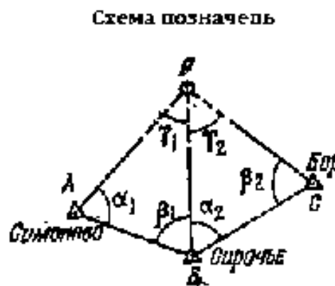
Схема 5.4 – Обчислення прямої засічки за таблицями логарифмів
