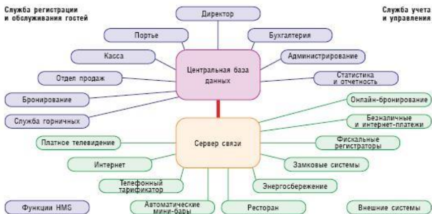
Рис. 1. Типичный состав модулей и внешних систем HMS
