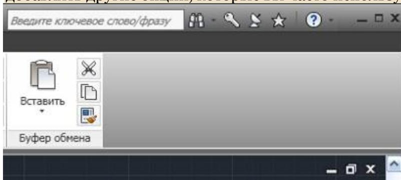
В правом верхнем углу расположен **Инфоцентр**, который выполняет поиск файлов справочной системы на сервере компании. Также здесь находятся кнопки управления приложением и кнопки управления окном чертежа, при помощи которых можно свернуть, развернуть или закрыть саму программу Автокад или отдельный чертеж.
