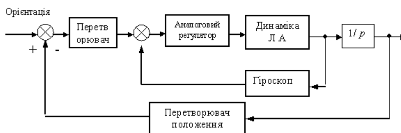
Рис. 1.3. Спрощена схема аналогового автопілоту
