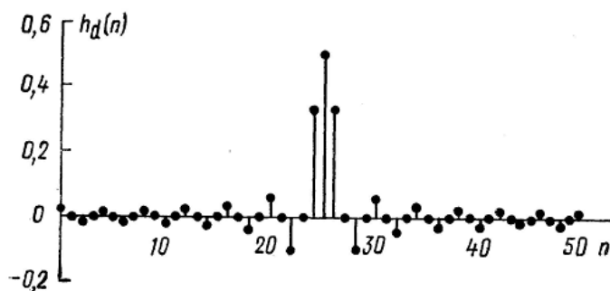
Рис. 3.1. Усікнена імпульсна характеристика ідеального ФНЧ
