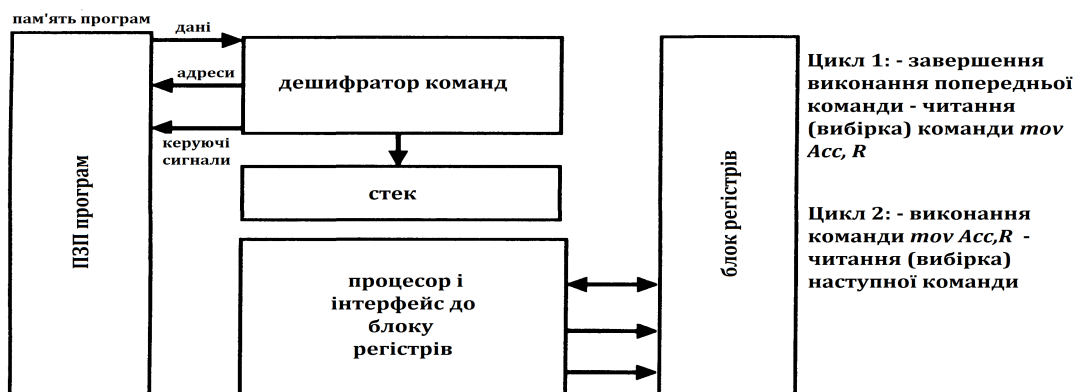
Рис. 6. Виконання команди mov Acc, Reg в Гарвардській архітектурі.
