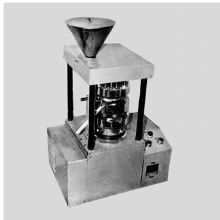
Рис. 43. Общий вид роторно-вибрационной таблеточной машины для прямого прессования лекарственных порошков
