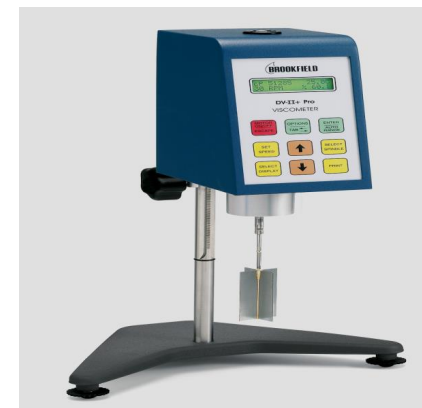
Рисунок 14 – Динамический ротационный вискозиметр Brookfield DV модели DV -II+ Pro
