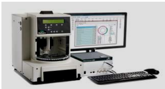
Рисунок 15 – Капиллярный вискозиметр Viscosizer 200, Malvern Instruments (Великобритания)
