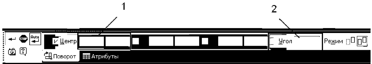
Рис. 7.18. Рядок команди повороту: 1 – зона завдання координат центру повороту, 2 – зона завдання кута повороту
