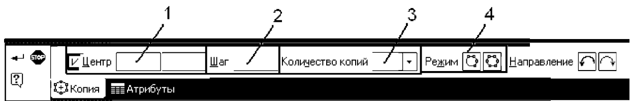
Рис. 7.23. Рядок команди « Копия по окружности »: 1 – центр кола, крок між об'єктами (в градусах), 3 – кількість копій, 4 – спосіб розташування об'єктів масиву
